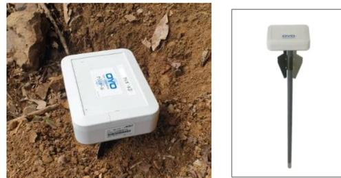
図-1 クリノメーター (地表面傾斜計)
