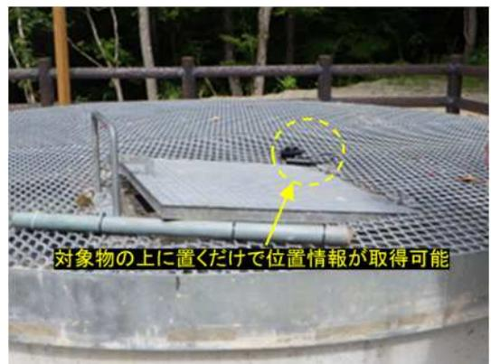
写真5 RTK-GNSSによる位置情報の取得状況
