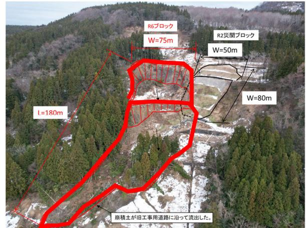
図-1 中野口地すべりのドローンによる全景写真
