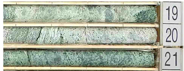
写真-1 コア写真 (H28-2 孔の蛇紋岩) 8)
