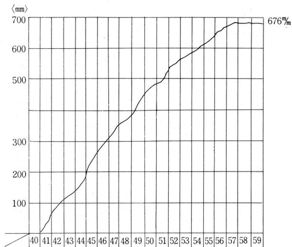
図-17 水圧鉄管縮み量累計曲線図
